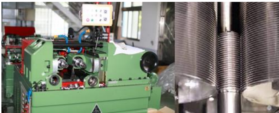
دستگاه رولینگ جهت ساخت پیچ مطابق با استانداردهای هوایی
