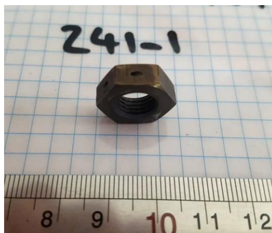
شکل ۲-۲: مقایسه شماتیک و تصویر قطعه NUT-PLAIN, DRILLED HEX.
